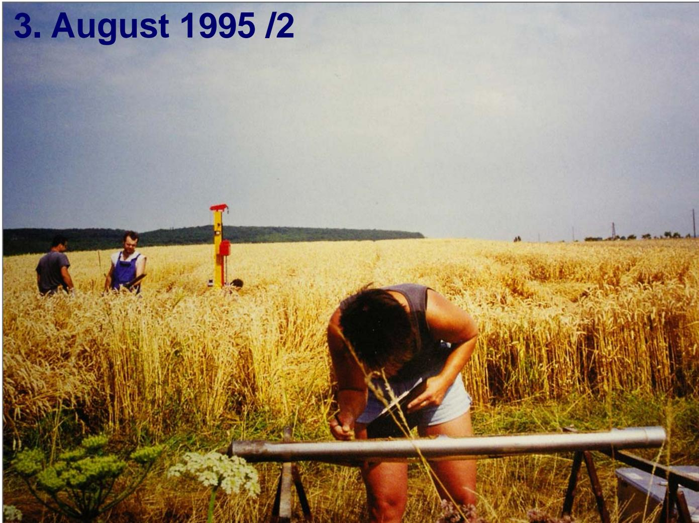
Hier wird das Bodenmaterial in der Bohrsonde begutachtet – im Fachchinesisch nennt sich das „Ansprache“. Die Ergebnisse werden in Protokollen peinlich genau festgehalten. Luftdicht verpackte Proben sind für die spätere Untersuchung im Labor bestimmt.
